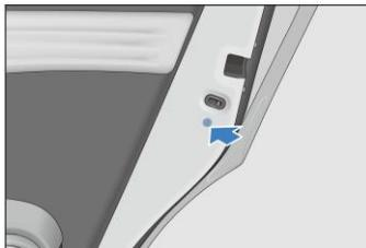
La etiqueta de advertencia de la pistola de carga está pegada en el panel interior de la tapa del puerto de carga.
